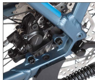
Shimano Scheibenbremse MT200 aus der günstigen Acera-Gruppe hat einstellbare Hebel, griffige Resin-Beläge und nutzt Mineralöl als Hydraulikflüssigkeit
